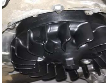
Gambar 1. Cooling fan dalam keadaan kotor
