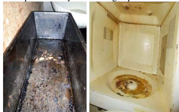
Gambar 1. Pengaratan pada bagian alat untuk proses produksi makanan
