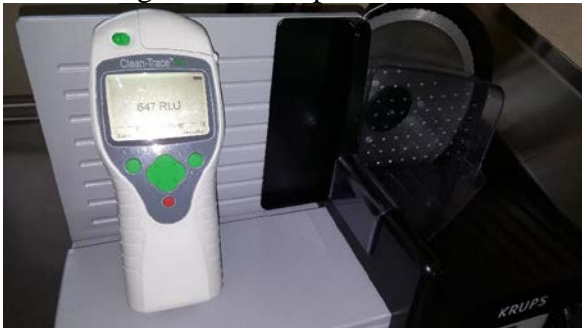
Gambar 7. Alat tes untuk memeriksa bakteri Di mesin pengiris atau pemotong terukur dibawah terukur 647 RLU (Seharusnya bisa dibawah 200 RLU dapat menjadi lebih baik).
