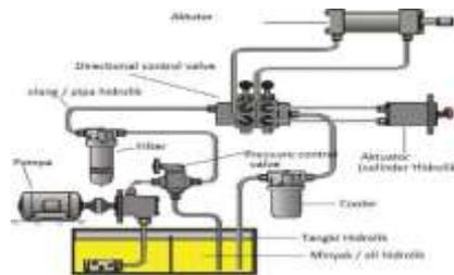
Gambar 2.1 Sistem Hidrolik
