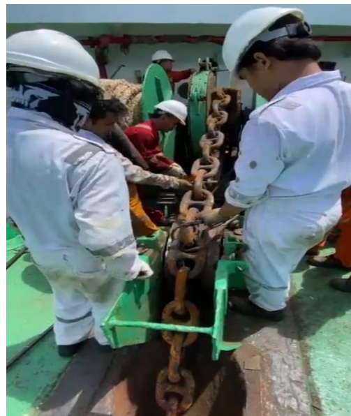
Gambar 3: Menyisipkan besi dimata rantai jangkar pada tromol windlass.
